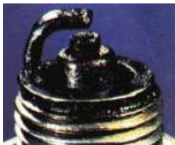
Mistura muito rica. Eletrodo preto e molhado de óleo.
